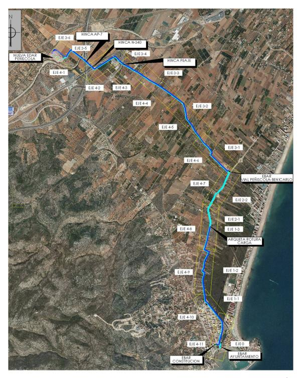
Vista general del trazado proyectado, en la que se observan los 4 ejes principales: Eje 1 Impulsión, Eje 2 Gravedad, Eje 3 Impulsión, Eje 4 Emisario. Asimismo, se observan las hincas, las dos EBAR previstas de nueva construcción (Vial y Constitución), así como la ubicación de la EBAR Ayuntamiento, que actualmente impulsa el vertido municipal al emisario submarino. Esta EBAR quedará fuera de uso, tras su rehabilitación interior.
